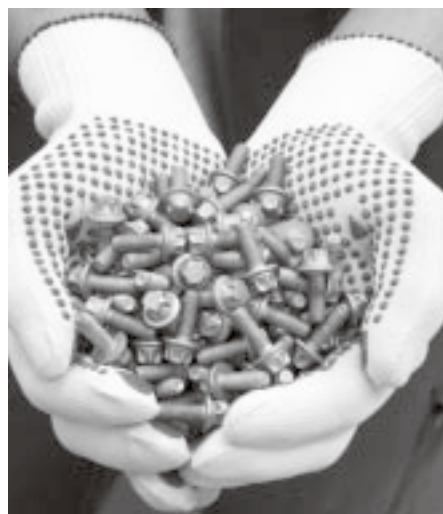
Diese Schrauben sind mit Dacromet beschichtet. Dieser Werkstoff enthält in geringen Spuren gesundheitsschädliche Chrom-6-Verbindungen.
