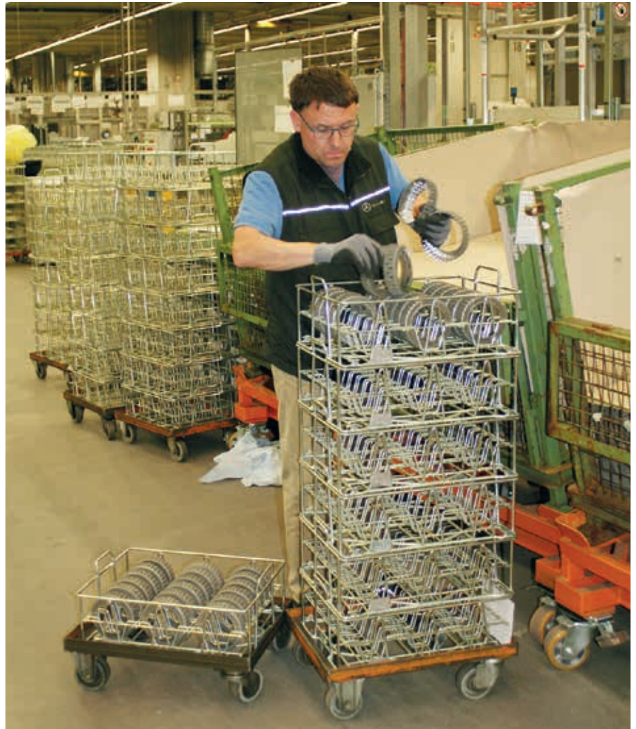
Der Supergau: Der Meister hat den Arbeitsplatz mitten auf einen Fahrweg der Stapler verlegt – ohne Fußmatten und Hebezeug
