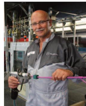
**Tüftler** | Alfred Dengler mit einer manuellen Hohlraumkonservierungs-Pistole mit Düsen-erkennung. Eine Weiterentwicklung der von ihm 1988 erfundenen Codierpistole für die manuelle Applikation.
