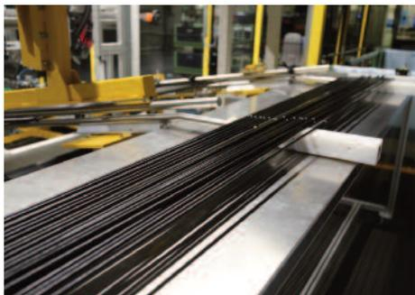
**Anpassungsfähig** | Die Rohrleitungen werden individuell an die unterschiedlichen Fahrzeugbaureihen angepasst.
