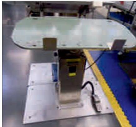
Dieser schwenkbare und höhenverstellbare Tisch kann individuell vom Mitarbeiter angepasst werden und fördert eine bessere Haltung an der Station.
