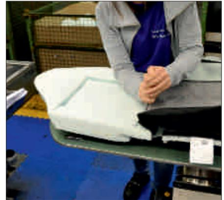
Durch passgenaue Halterungen am Tisch werden die Bezüge unter weniger Kraftaufwand befestigt.
